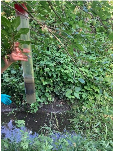
HN: 5 cm vand og 5-20 cm sediment Sedimentlag særlig tykt i midten af vandløbet.
