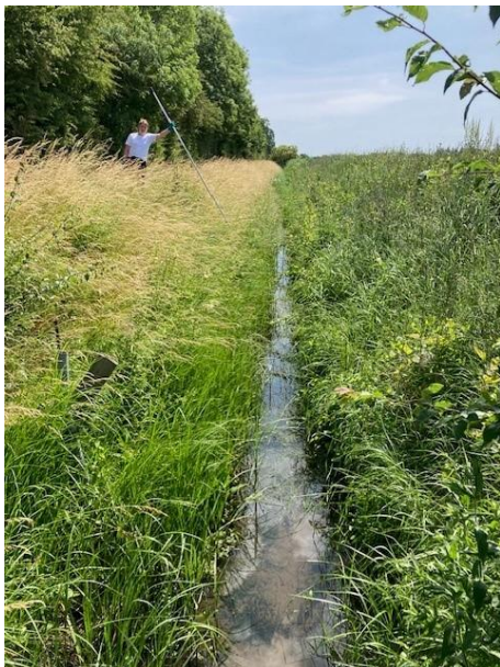
HF: 10 cm vand og ca. 15 cm sediment. Der kunne ikke dannes prop med kajakrøret, og prøven er derfor udtaget med skovl.
