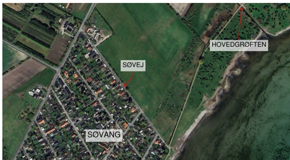
Figur 3-1 Til beskyttelse af Søvang i den midlertidige fase mellem Etape 1 og 2 bør der etableres en forhøjelse af fløjde langs med østsiden af Søvej samt højvandslukke i hovedgrøften.
