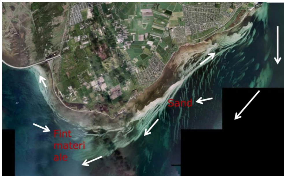
Figur 4-16 Princip for sedimentation langs Dragør Kommunes sydlige kyst. Pile indikerer dominerende materialetransport. Fra ref. /5/.
