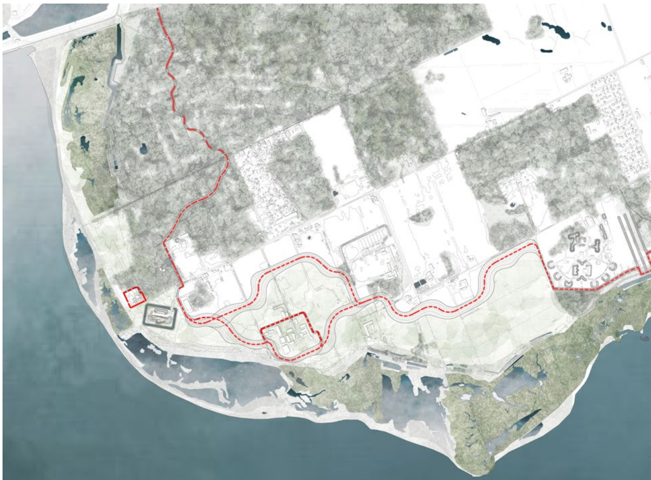
Figur 6-6 Plantegning for delområde 5 og 6. Rød stiple: Sikringslinje (top kystbeskyttelse). På delstrækning 5 er vist begge optioner (fremskudt dige og tilbagetrukket dige). I optionen med tilbagetrukket dige (bag om TAMU), etableres en lokal løsning omkring TAMU. Den lokale løsning omkring TAMU etableres ikke i option fremskudt dige.
