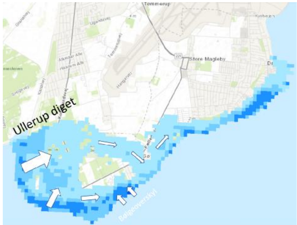
Figur 3.4: Oversvømmede områder med vanddybder ved en 100 års stormflod i 2019 under eksisterende digebeskyttelse. Pilene viser, hvordan vandet først løber ind over de lave diger i syd suppleret med bølgeoverskyl over digerne fra Søvang-Dragør og derefter forplanter sig op langs kysten bag de højere
